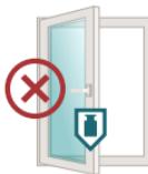
Запрещается прикладывать чрезмерное усилие к элементам конструкций (например, навешивать тяжести на створку).
